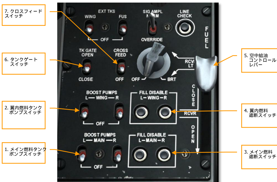
図298. 燃料システムパネル
