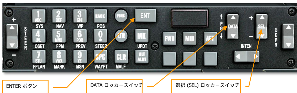
図 401. Up Front Control UFCパネル
