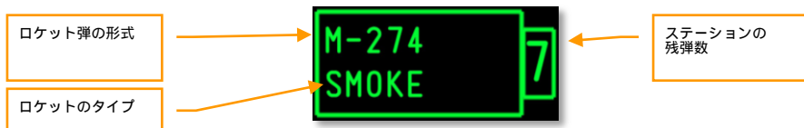
図 408. ロケットが装填されたステーション
