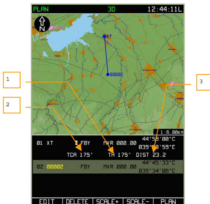
7-42: MENU/PLAN Sub-Modus nach dem Hinzufügen eines neuen Wegpunkts zur Flugroute
