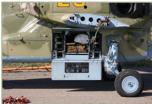
2-2: Hubschrauber mit demontierten Stummelflügel und geöffneter Wartungsklappe
