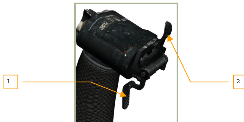
6-7: Waffenauslöseschalter (groß) und Bordkanonen-Feuerknopf (klein) im Bordkanonen-Modus – Waffenauslöseschalter (groß) ist hochgeklappt
