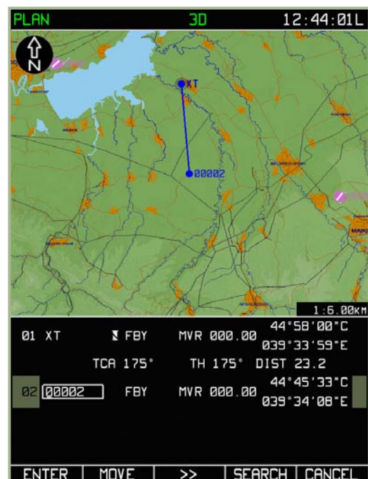
7-40: Einsetzen eines neuen Wegpunkts im MENU/PLAN Sub-Modus
