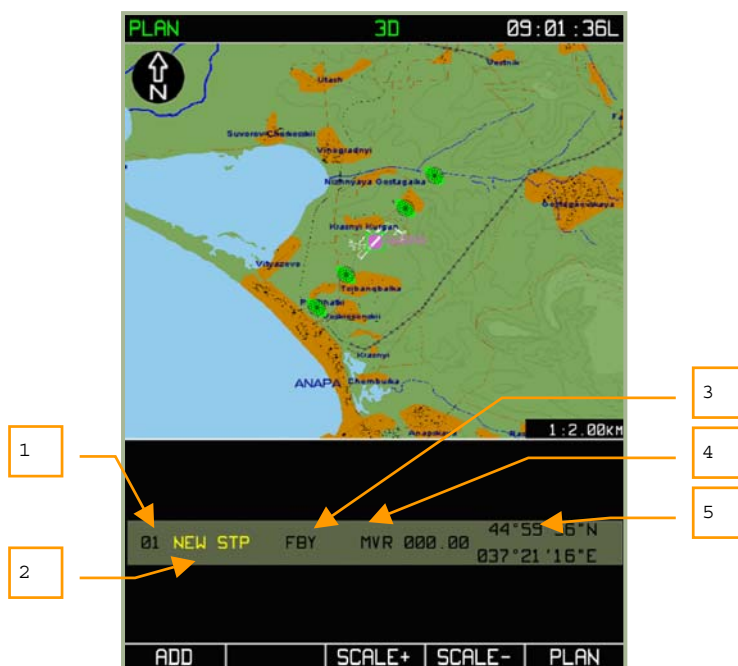
7-29: MENU/PLAN Display beim manuellen Eingeben eines Wegpunkts
