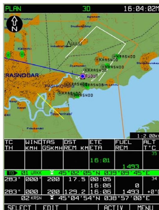
7-66: MENU/PLAN Sub-Modus vor der Aktivierung der Flugroute
