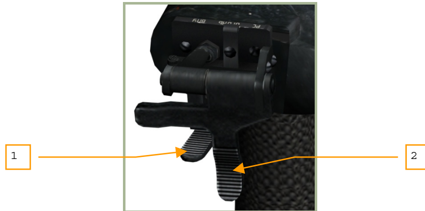
6-6: Waffenauslöseschalter (groß) und Bordkanonen-Feuerknopf (klein) in Normalstellung – Waffenauslöseschalter aktiv
