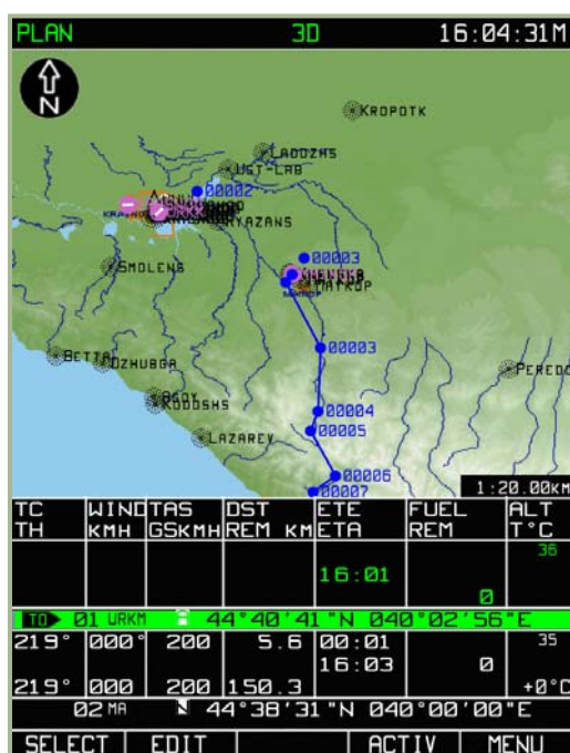
7-69: PLAN Sub-Modus nach dem Laden einer Flugroute
