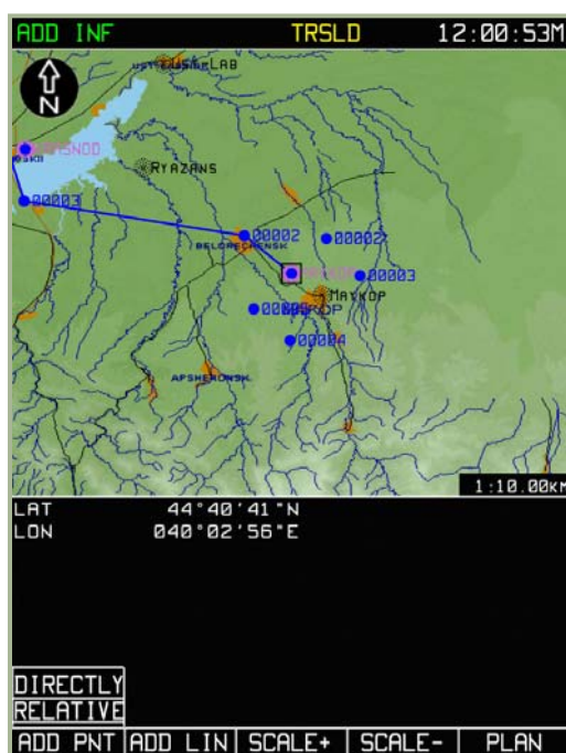
7-83: Markierung eines Punkts bei bekanntem Azimut und Entfernung (RELATIVE Modus)
