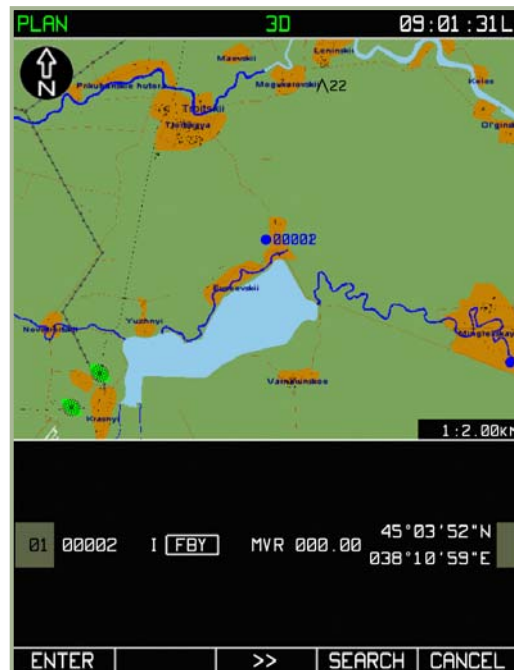
7-35: MENU/PLAN Sub-Modus nach erfolgreicher Suche eines Wegpunkts durch das Suchen eines Wegpunktrufnamens
