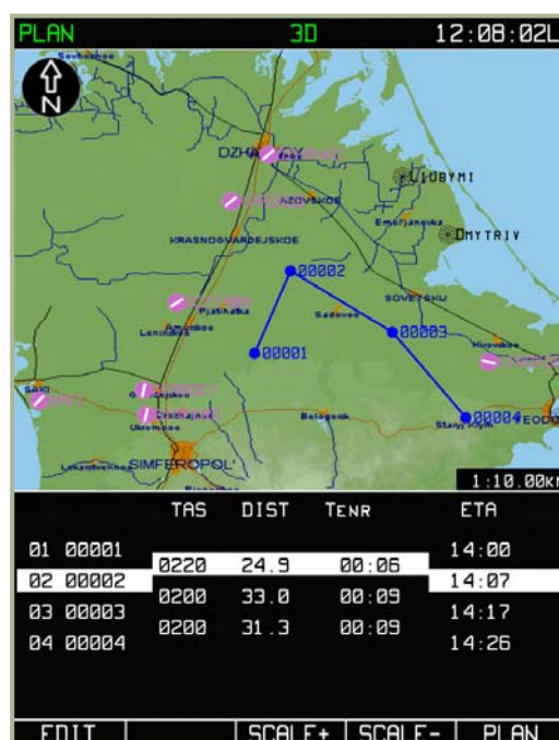
7-48: SPEED Sub-Modus mit Ansicht der Abflugzeiten sowie der Fluggeschwindigkeiten bei den einzelnen Flugabschnitten
