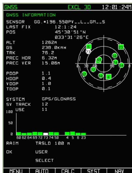
7-101: Die SYST Seite während der Überprüfung des GNSS Sensors und seines Kommunikationskanals
