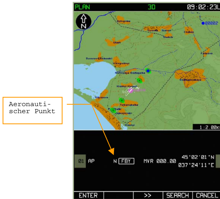
7-32: MENU/PLAN Anzeige nach dem Erstellen eines Wegpunkts über einem Kartenobjekt
