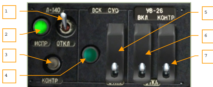
6-70: Bedien- und Testeinheit für Laserwarnsystem L-140, Feuerleitsystem und UV-26 Gegenmaßnahmensystem
