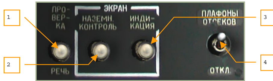
6-67: Bedienpanel des Internen Diagnose- und Warnsystems EKRAN und der ALMAZ Sprachmittlungseinheit ("Betty") BIT (Build In Test)
