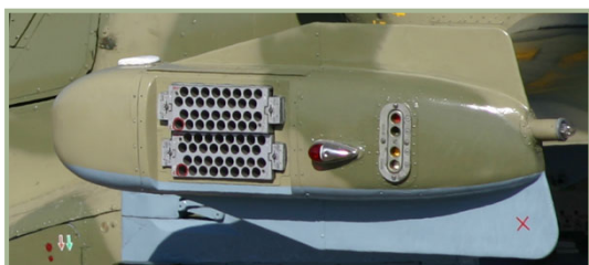
2-9: Linker UV-26 Fackelautomat, mit dem roten Positionslicht und dem Auswurf-Behälter für die Täuschkörper
