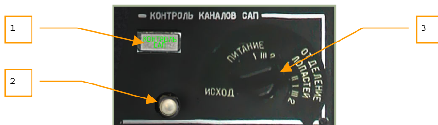
6-65: Panel für Notausstiegssystem BIT (Build In Test)
