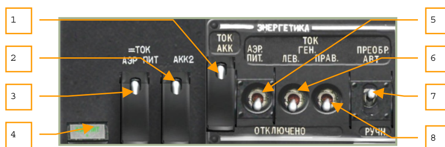
6-52: Panel für elektrische Energieversorgung
