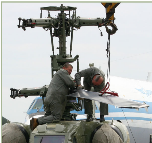
2-4: Montage des Rotors
