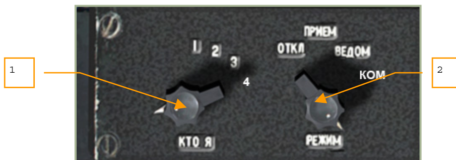
6-44: PVTz-800 Panel für die externe Zieldatenübertragung via Data Link
