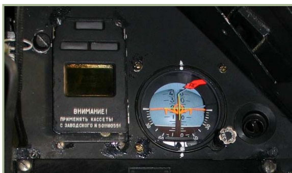
2-5: EKRAN Kontrollsystem (links) und der Ersatz-Fluglagenanzeiger (rechts)
