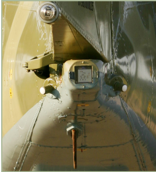
2-6: Heck des Ka-50 mit weißem Positionslight, ein von IFF Antennen flankierter Sensor des L-140 „Otklik“ befindet sich in der Bildmitte
