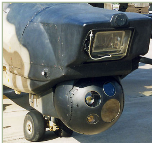
1-12: Ka-50Sh Nase mit dem „Skhval“ System oben und dem elektro-optischen Samshit-50 System unten
