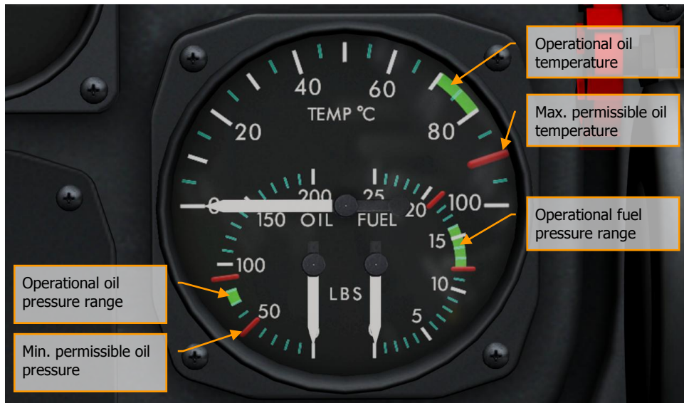
Figura 83: Indicatore Pressione Olio e Temperatura
