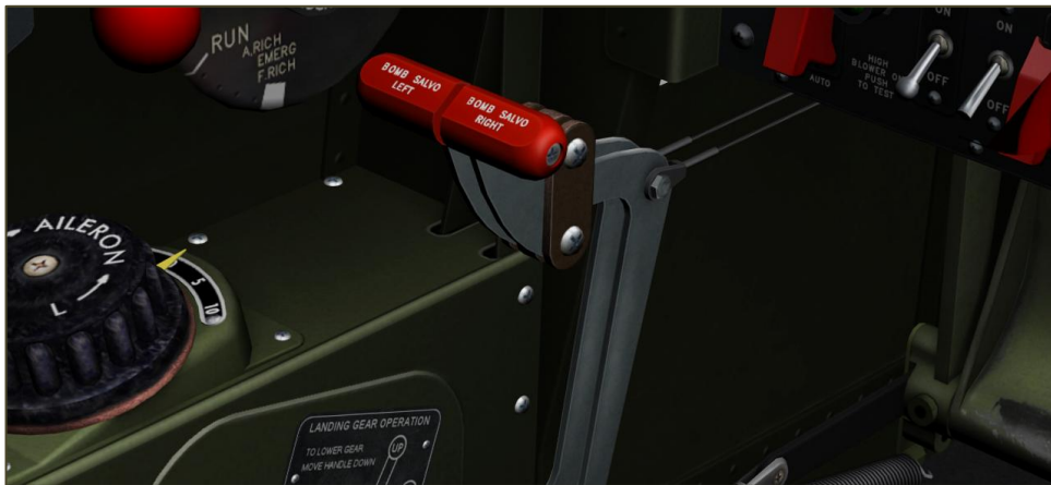
Figura 69: Leva blocco rilascio bombe
