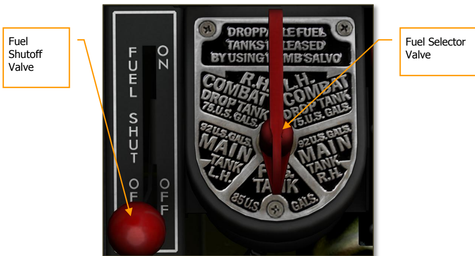
Figura 60: Selezione valvole e chiusura carburante
