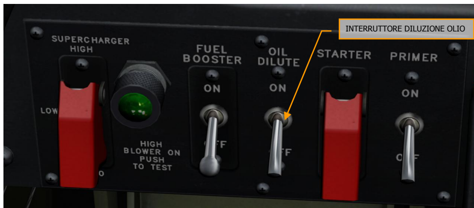
Figura 23: Interruttore diluizione olio
