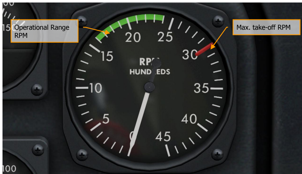
Figure 84: RPM massimi per il decollo 3000. Limiti operativi 1600...2400.
