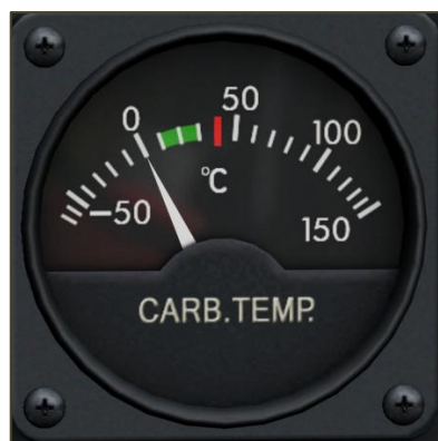
Figura 48: Indicatore temperatura aria carburatore
