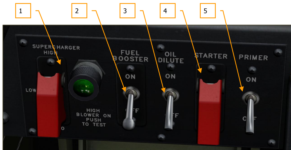
Figura 58: Pannello di controllo motore
