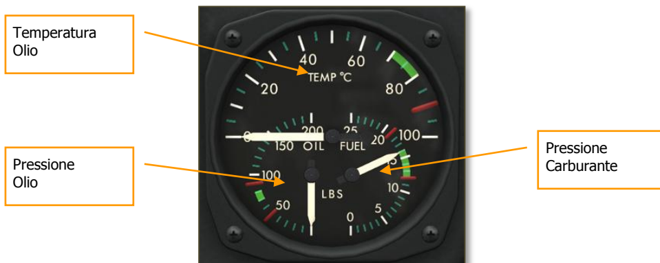
Figura 50: Manometro motore
