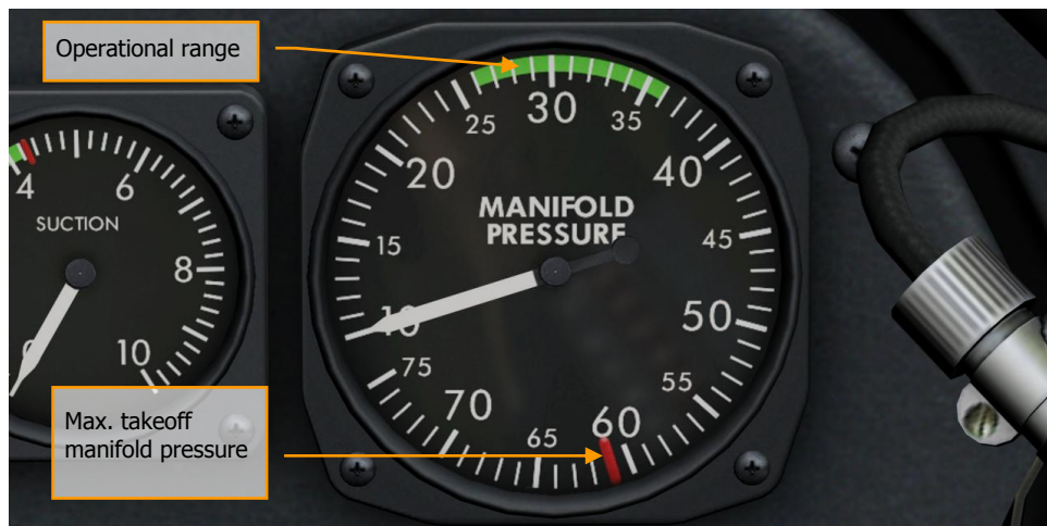
Figura 82: Massima pressione manifold di decollo – 61 in. HG (155 cm HG) (linea rossa). Limiti operativi 26...36 in. HG (66.04 - 91.44 cm HG) (zona verde).
