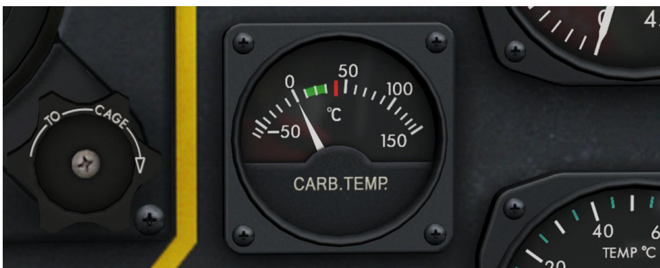
Figure 87: Limiti operativi della temperatura dell'ariadel carburatore 15-30°C (59...86°F), massimo 40°C (104°F)
