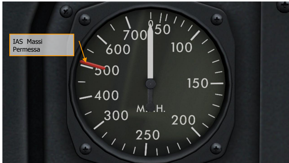
Figura 85: Massima velocità IAS 505 mph (808 km/h, 440 knots)
