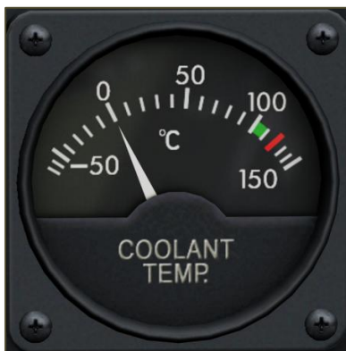
Figura 49: Indicatore temperatura refrigerante
