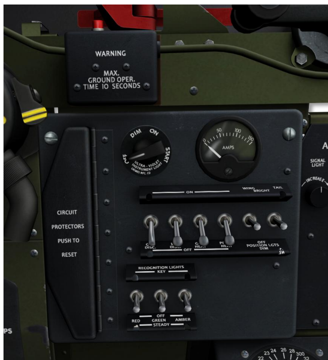
Figura 25: Pannello di Controllo Elettrico
