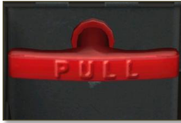
Figura 62: Leva d'emergenza rilascio carrello d'atterraggio
