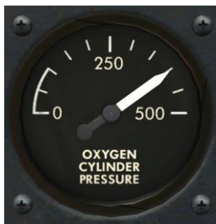
Figura 54: Manometro pressione ossigeno
