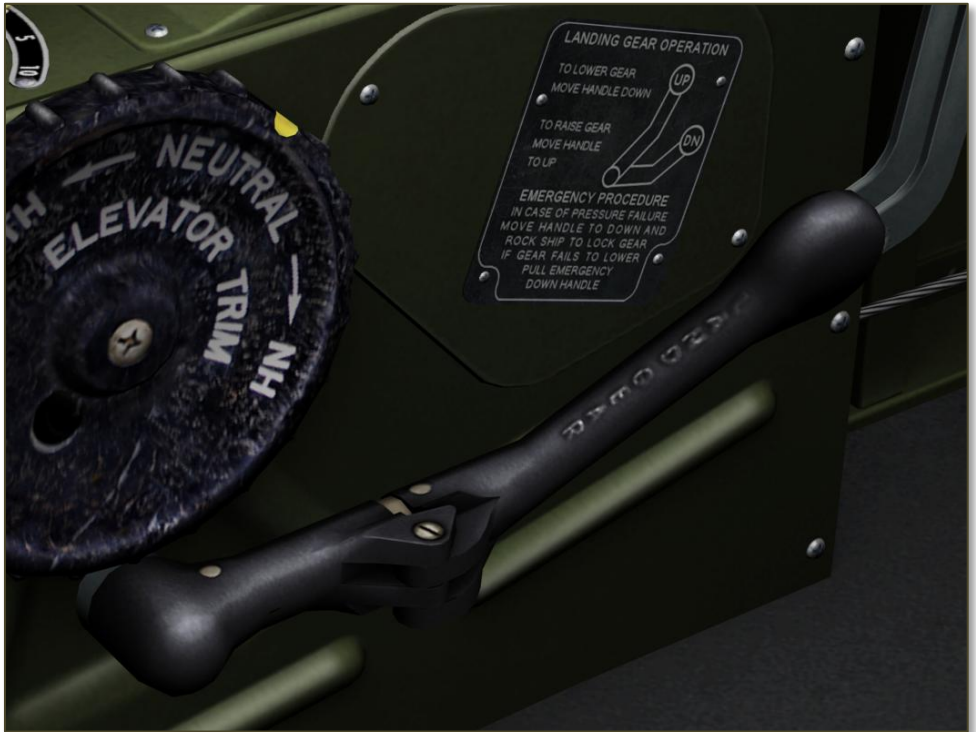
Figura 70: Leva carrello d'atterraggio
