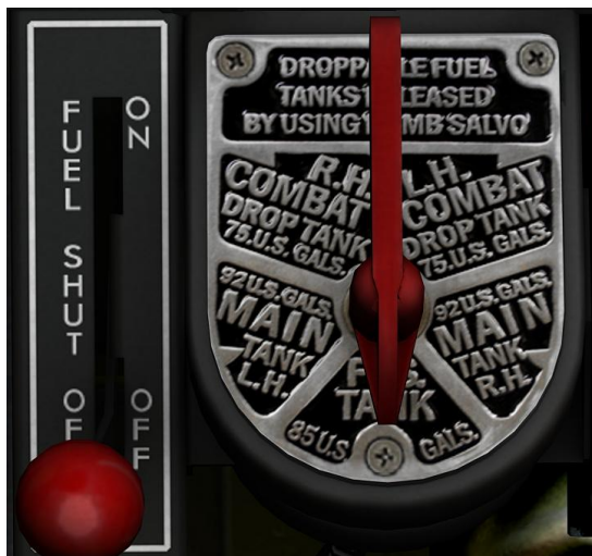
Figura 18: Selettore Valvola Carburante
