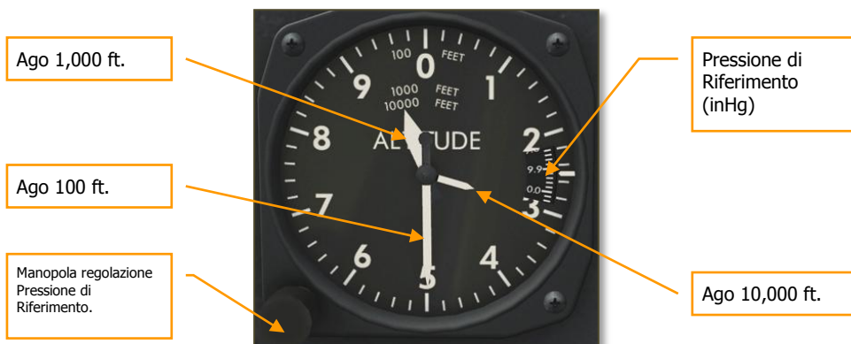
Figura 44: AN5760-2 Altimetro indicante: 29,500 ft.
