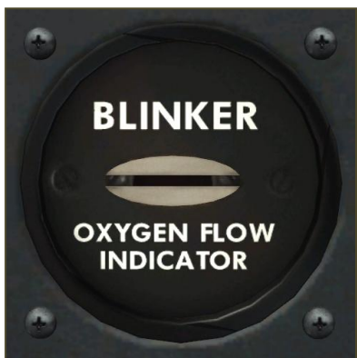
Figura 53: Indicatore flusso di ossigeno
