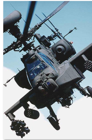
El AH-64D equipado con el radar montado en mástil AN/APG-78 Radar de Control de Fuego (Ejército de EE. UU.)
