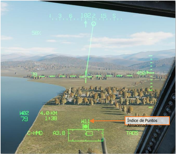
Almacenar un punto utilizando la línea de visión del HMD
