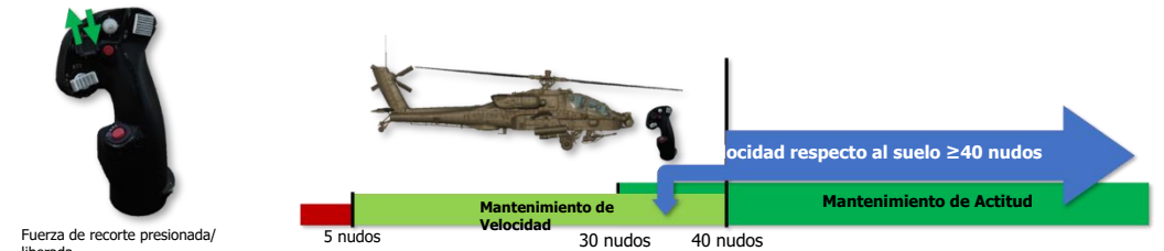
Modo de mantenimiento de velocidad activado si se presiona el ajuste de fuerza a menos de 40 nudos
