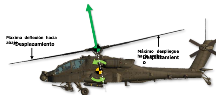
El batimiento de las palas inclina el disco del rotor con entrada cíclica.
